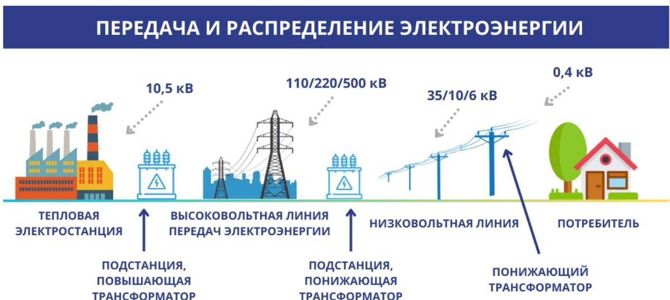
Этап распределения электроэнергии начинается на подстанциях, где высокое напряжение понижается до уровня, безопасного для конечных пользователей. Так, для передачи энергии на большие расстояния используется высокое напряжение, чтобы снизить потери энергии. В линиях электропередач используется переменный ток (АС) или постоянный ток (DC). Трансформаторы помогают изменять уровень напряжения: его повышают для передачи на большие расстояния и понижают для местного использования.
